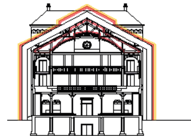
04* VOORKEURSMODEL - NIEUWE BUITENSCHIL (MINIMAAL 1500MM)
