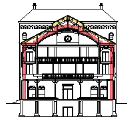
03 DAK VERZWAREN EN VOORZETWANDEN (600MM)
