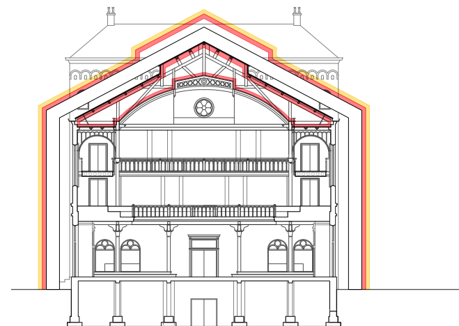
04* VOORKEURSMODEL - NIEUWE BUITENSCHIL (MINIMAAL 1500MM)
