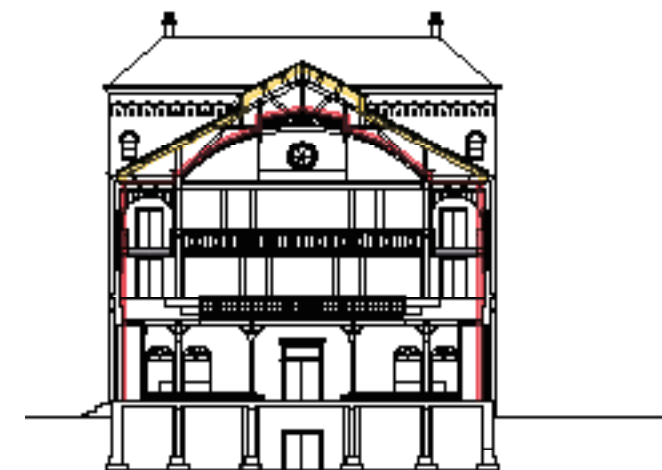
02 DAK VERZWAREN + ISOLEREN EN VOORZETWANDEN (200MM)
